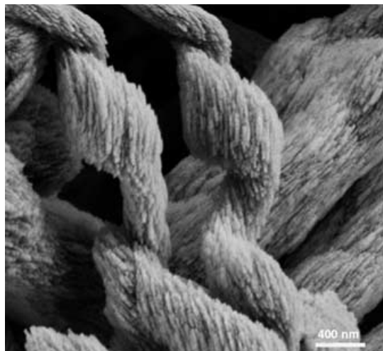
Abbildung 20. REM-Aufnahme von helicalen BaCO 3 -Fasern, die in Gegenwart eines steifen phosphonierten Blockcopolymers gebildet wurden. Abdruck aus Lit. [84] mit Genehmigung der Nature Publishing Group.
